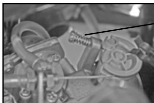
Vis de réglage de la vitesse de ralenti
