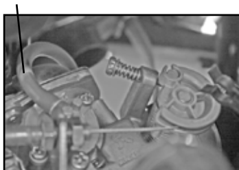
Tuyau de combustible
