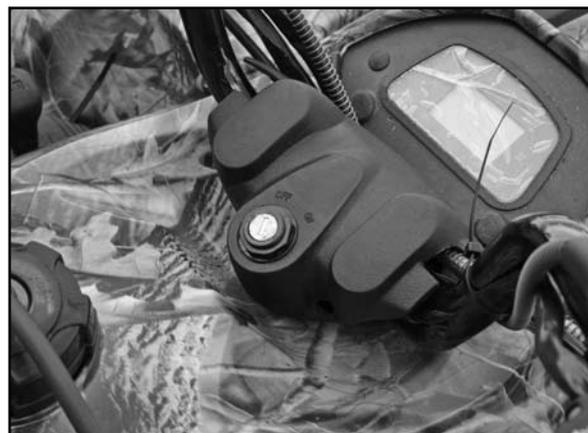
12. Poussez la couverture protectrice du guidon pour la sécuriser en place.
