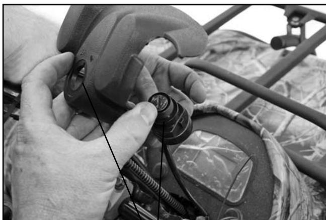
11. Placez le commutateur d'allumage dans le trou de la couverture protectrice du guidon.
