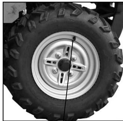
15. Gonflez tous les pneus à la pression recommandée de 25 PSI en utilisant l'adaptateur du compresseur à air, vérifiez la pression en utilisant le manomètre de pression de pneu.
