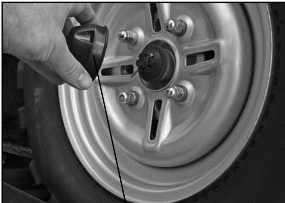
14. Attachez les couvertures protectrices sur les quatre roues.
