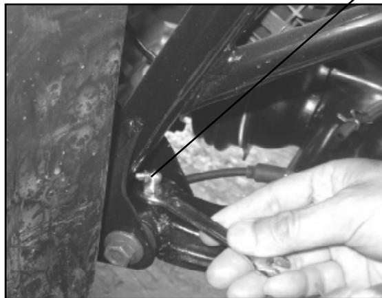
7. Dans la fourche arrière, il y a deux trous de graissage ; un se trouve sur le côté droit et l'autre se trouve sur le côté gauche. Installez les embouts de graissage dans les trous en utilisant une clé à molette.
