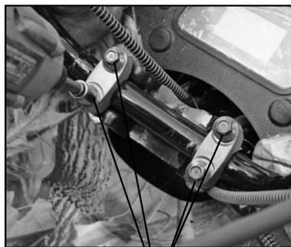
10. Sécurisez le guidon en utilisant les boulons du guidon fournis.
