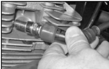
2. tourner la clé de démarrage en position « run » marche. pousser le commutateur d'arrêt du moteur en position « RUN » (le bouton gris). Si le système d'allumage opère proprement, une étincelle bleue devrait être envoyée à travers l'écartement des électrodes de la bougie. Si il n'y aucune étincelle, apporter votre véhicule chez votre centre de service.
